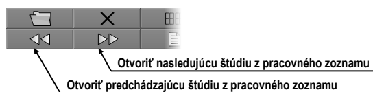
obr. 124 – Tlačidlá pre prácu s pracovným zoznamom v paneli nástrojov mamografického režimu
